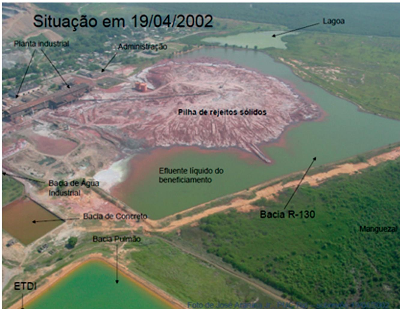
Figura 4 – Visão aérea do depósito de rejeito da Indústria INGÁ em 2002
